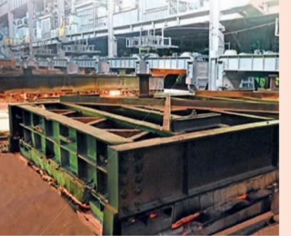
В обжимном крупносортном цехе на стане 1150 обновляют футеровки крышек нагревательных колодцев. Новый материал, которым «накрыли» колодцы, позволяет сэкономить энергоресурсы до 40%.
