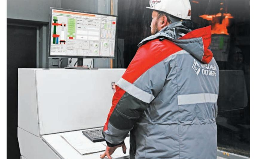
Напомним, что в ЭСПЦ-3 модернизированы и введены в эксплуатацию дополнительные печи ЭШП. Помимо проведенной замены системы управления были установлены новые трансформаторы мощностью 2500 кВт.
