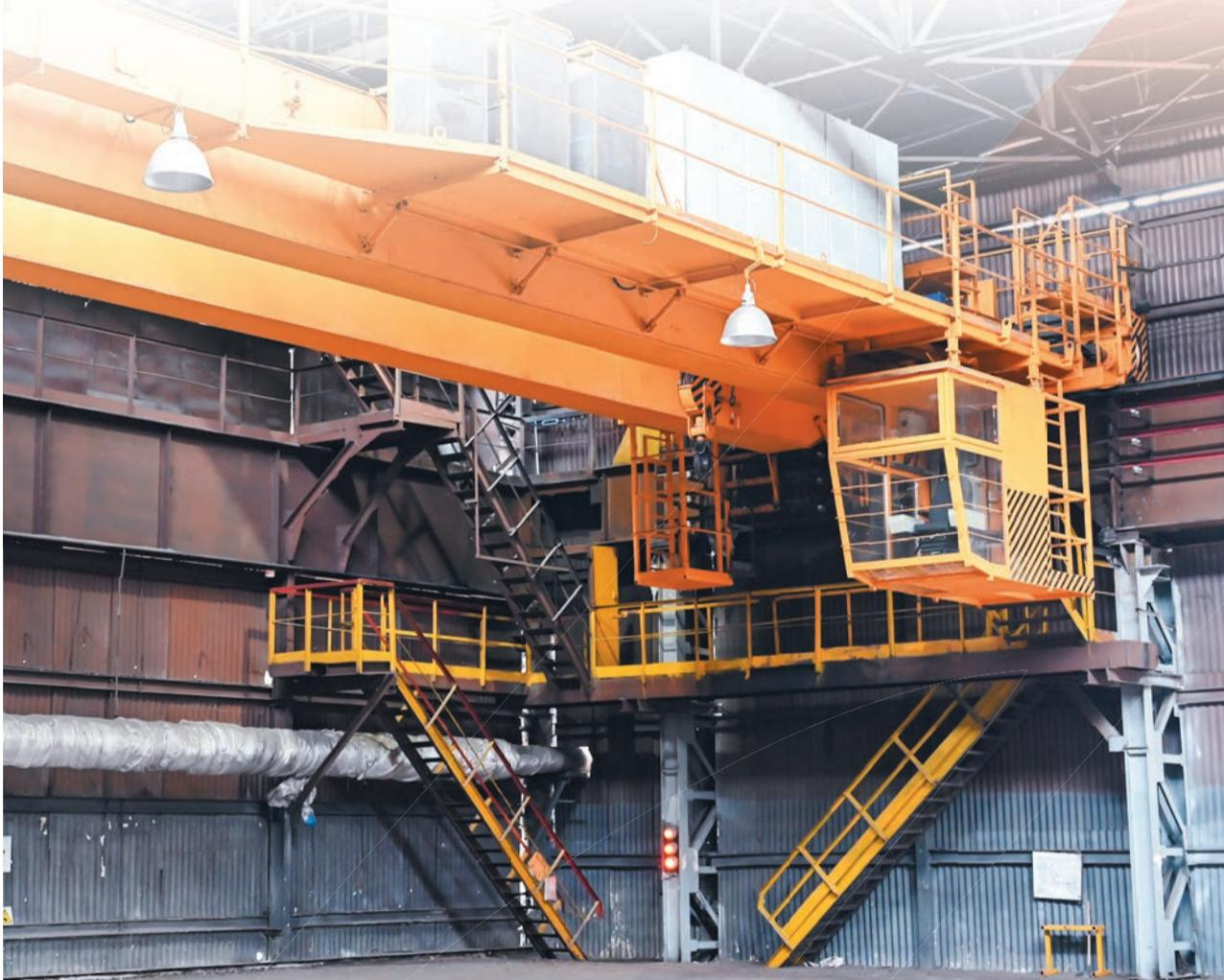
В отделении горячего проката обжимного крупносортного цеха введен в эксплуатацию современный 15-тонный мостовой кран.
